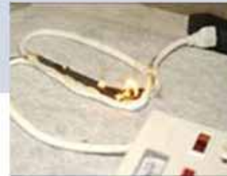
Los artículos pirata sustituyen un conductor calibre 24 por uno calibre 16, provocando un riesgo potencial de incendio
